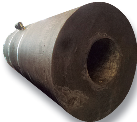
Camisa bruta com corpo de prova em apenso.
